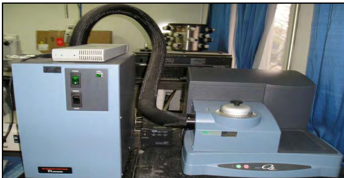
Figura 10. Calorímetro Diferencial de Barrido Q 10, TA Instruments
