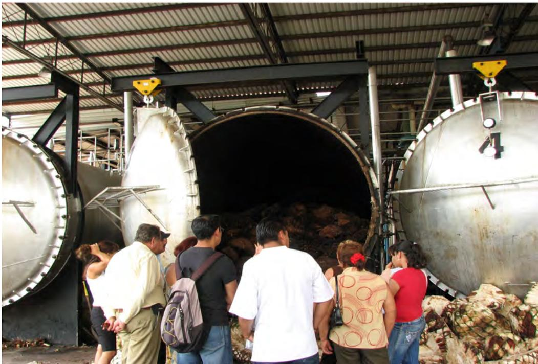
Figura 3 Autoclave utilizado para la elaboración del tequila.
