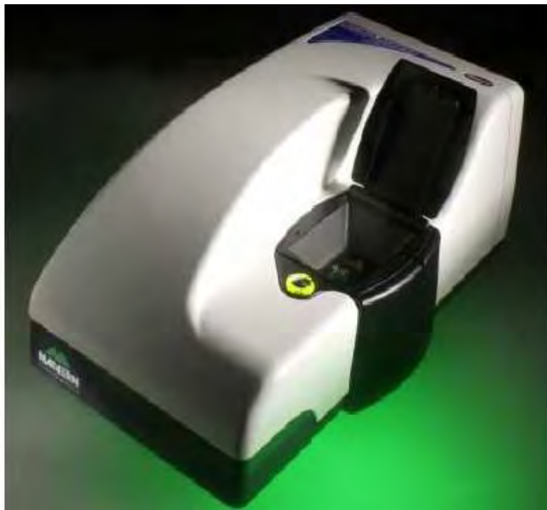
Figura 25: Fotografía de uno de los instrumentos comerciales más utilizados para la determinación del tamaño y potencial zeta de las nanopartículas ( www.malverninstruments.com ).
