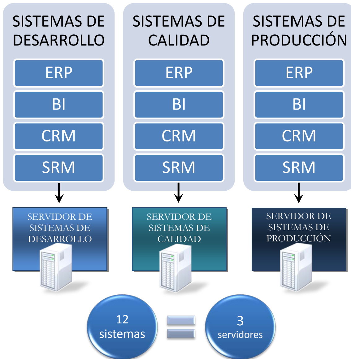
Figura 12. Doce sistemas SAP pueden alojarse en 3 servidores al agrupar las bases de datos de los sistemas de desarrollo, calidad y producción en MCOB.
