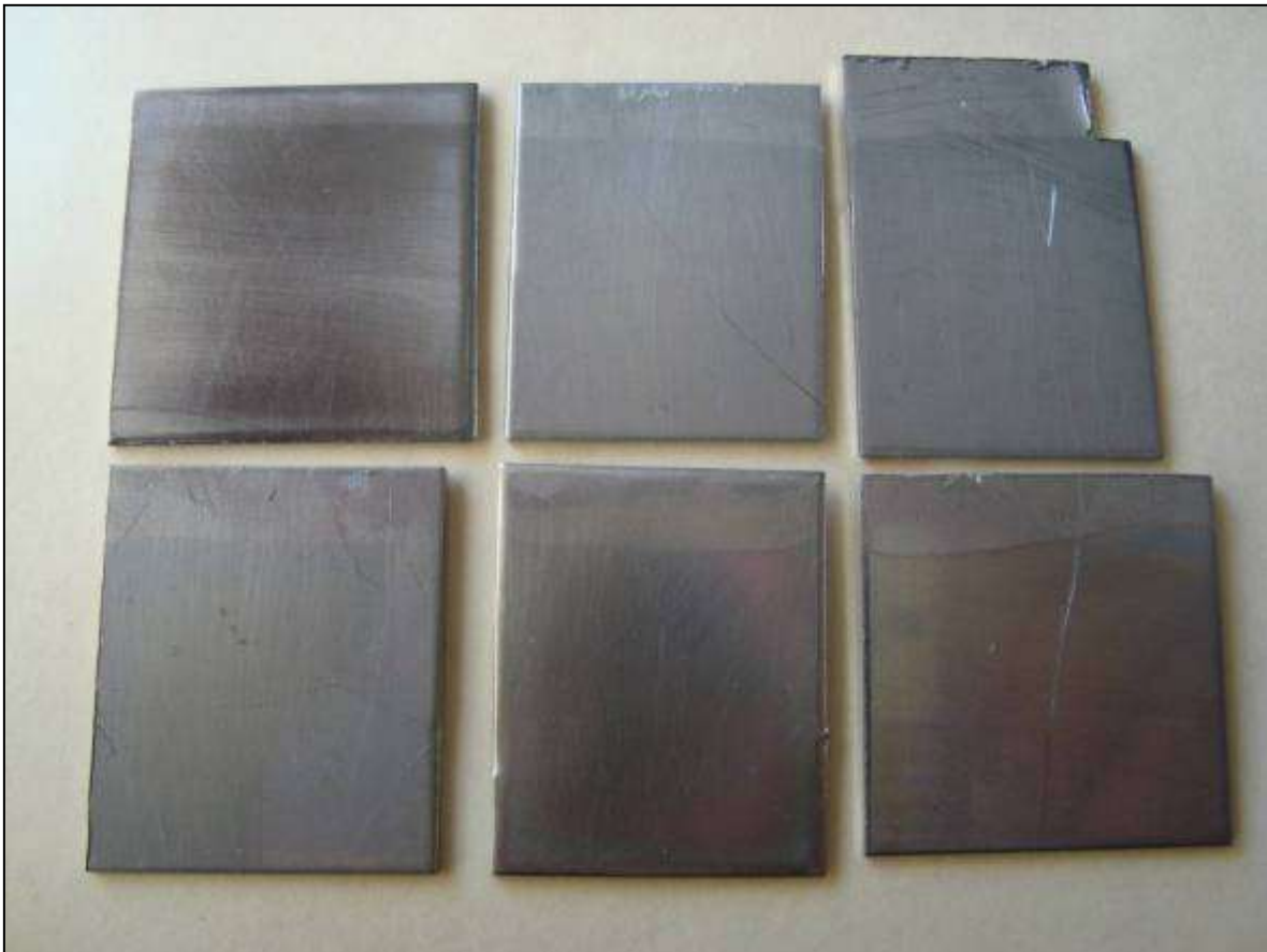
Figura 4.23 Recubrimientos híbridos PMMA-sílice depositados sobre acero inoxidable 316L
