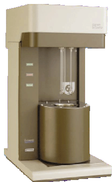
Figura 1.13 Fotografía del analizador de área superficial utilizado en esta tesis de marca BEL Japan modelo Belsorp-Mini II.
