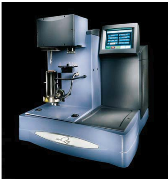
Figura 1.15 Fotografía del equipo de TGA utilizado en esta tesis de marca TA Instruments modelo Q500HR.
