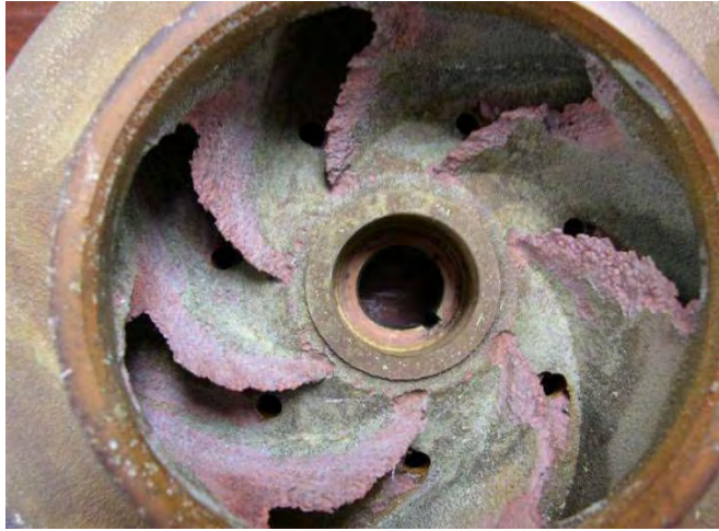
Figura 2.8 Impulsor desgastado que provoca disminución de caudal.
