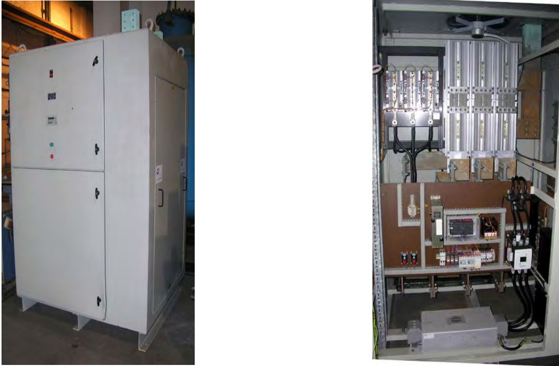
Figura 1.3 Rectificador trifásico controlado y sus componentes internos.
