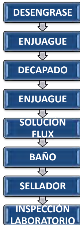
Diagrama 1.1 Proceso de la Galvanostegia.
