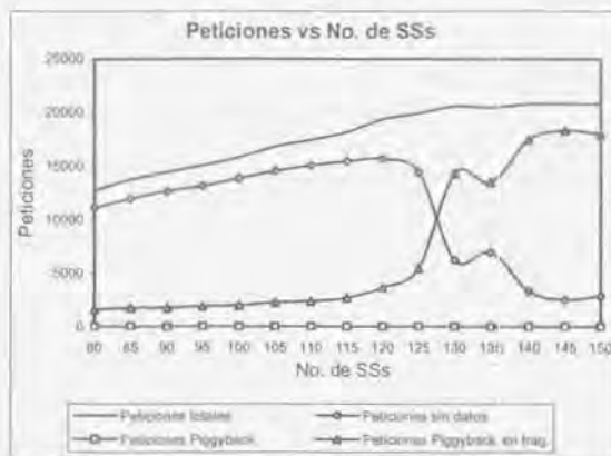
Figura 5.12 Peticiones totales, peticiones con datos y peticiones en piggyback vs número de SSs.
