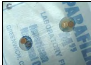
IMAGEN (42): Rejillas con membrana fomvar
