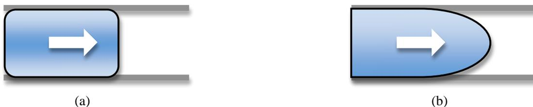
Figura 5. Perfil del flujo electroosmótico (a) y el generado por presión hidrostática (b).
