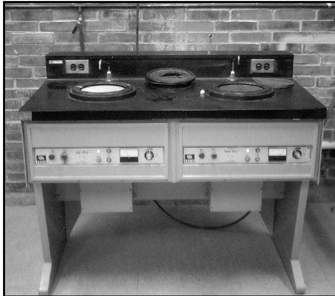
Figura 5.4 Pulidora de disco marca LECO modelo Vari/Pol VP-50 @ 500 rpm
