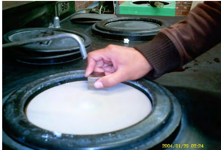
Figura 6 Pulido de la superficie de la muestra
