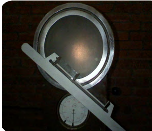
Figura 15 Pantalla de medición de la huella obtenida por el penetrador
