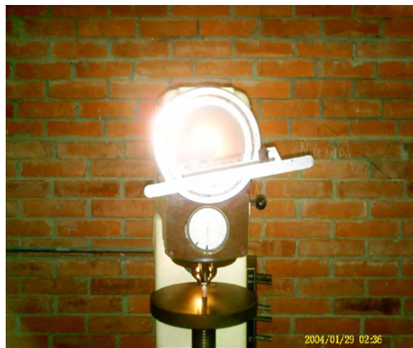
Figura 14 Durómetro marca Amsler Otto Wolper
