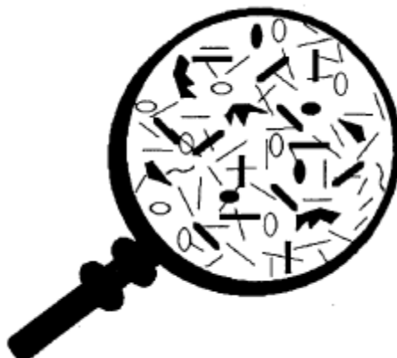
Figura 1.29. Orgánicos pesados en el petróleo crudo (líneas rectas/curvas = moléculas de parafinas, elipses sólidas = moléculas aromáticas, elipses abiertas = moléculas de resinas, y formas de bloques sólidos = moléculas de asfalteno) (reimpreso de Journal of Petroleum Science and Engineering , Vol. 17, Mansoori, G. A., "Modeling of Asphaltene and Other Heavy Organic Depositions", pp. 101-111, ©1997, con permiso de Elsevier Science; después SPE; reimpreso con permiso de la Society of Petroleum Engineers).
