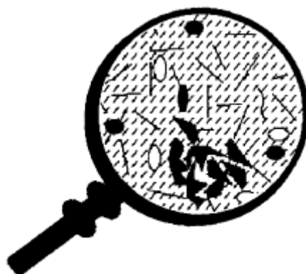
Figure 1.31. Floculación y precipitación de componentes pesados por la adición de un solvente no polar miscible (línea en forma de guión = un hidrocarburo parafínico) (reimpreso de Journal of Petroleum Science and Engineering , Vol. 17, Mansoori, G. A., "Modeling of Asphaltene and Other Heavy Organic Depositions, pp. 101-111, ©1997, con el permiso de Elsevier Science; después de Mansoori ©1994 SPE; reimpreso con el permiso de la Society of Petroleum Engineers).
