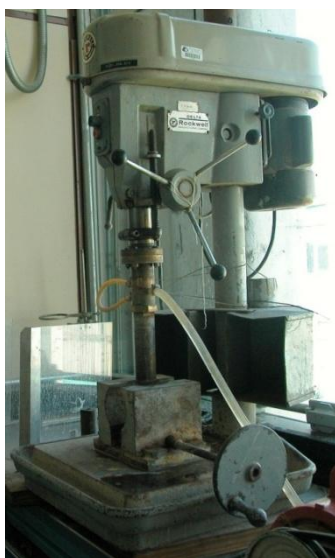
Figura 4.1. Taladro corta-tapones de núcleo.
