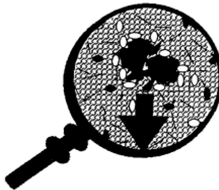
Figura 1.34. Floculación y depositación (flecha grande) de grandes partículas orgánicas pesadas (reimpreso de Journal of Petroleum Science and Engineering , Vol. 17, Mansoori, G. A., "Modeling of Asphaltene and Other Heavy Organic Depositions, pp. 101-111, ©1997, con el permiso de Elsevier Science; después de Mansouri ©1994 SPE; reimpreso con el permiso de la Society of Petroleum Engineers).
