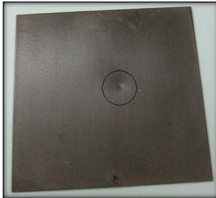
Figura (24): Placa después del ensayo, muestra el desprendimiento de la capa de óxido en la zona señalada. Lado que fue directamente golpeado por el Identador.
