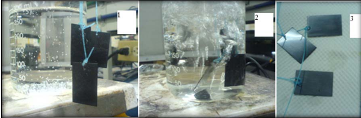
Figura (14): Muestra la forma en la cual las placas pavonadas se limpiaron de los residuos de la solución pavonante.
