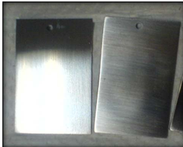
Figura (13): Acero 1018 (lija No. 600) antes de someterse al tratamiento de pavonado.
