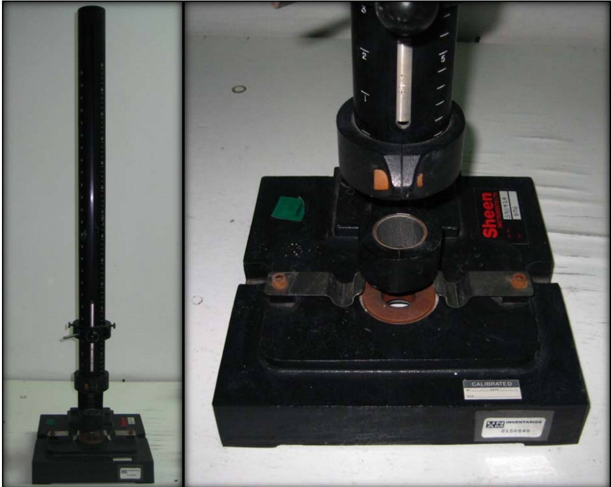
Figura (21): Equipo tubular con el cual se realizó la prueba de absorción de energía.
