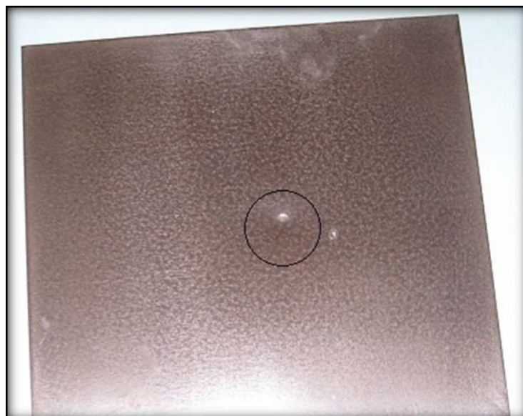
(25): Placa después del ensayo, muestra el desprendimiento de la capa de óxido en la zona señalada. Lado que fue directamente golpeado por el Identador.
