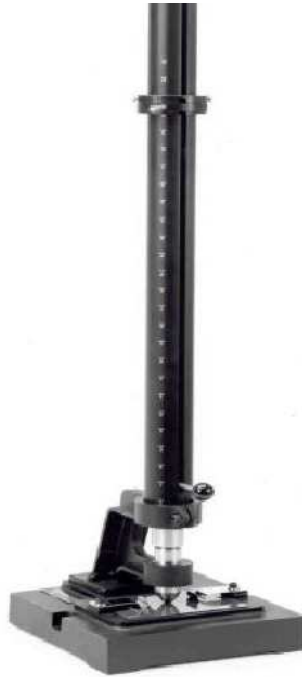
Figura (10): Equipo tubular para impacto en el cual se realizaron los ensayos de absorción de energía.
