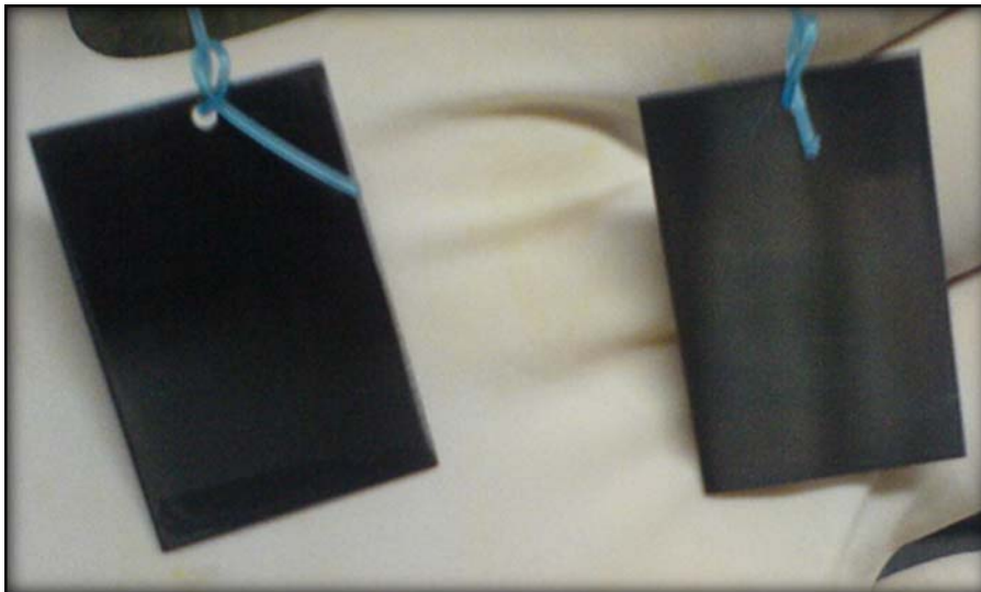
Figura (15): Acero 1018 (lija No. 600) después de someterse al tratamiento de pavonado y posteriormente a la limpieza de residuos de la solución pavonante.
