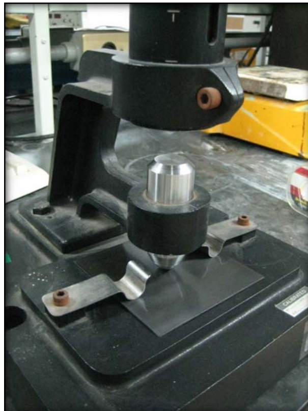
Figura (23): Forma en la cual se colocó la placa para el impacto.
