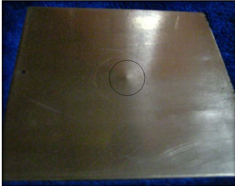
Figura (26): Placa después del ensayo, la cual muestra que no hubo el desprendimiento de la capa de óxido en la zona señalada. Lado que no fue golpeado directamente.
