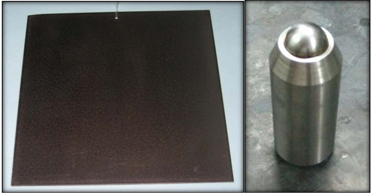
Figura (22): Placa de acero (1018) con dimensiones: 10 X 10 X 0.1 cm pavonada lista para el ensayo de absorción de energía.
