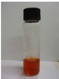
Figura 9. Viales utilizados para la MEFS. Se pueden distinguir la muestra en color rojo y el espacio restante entre la muestra y el tapón se conoce como espacio de cabeza o headspace
