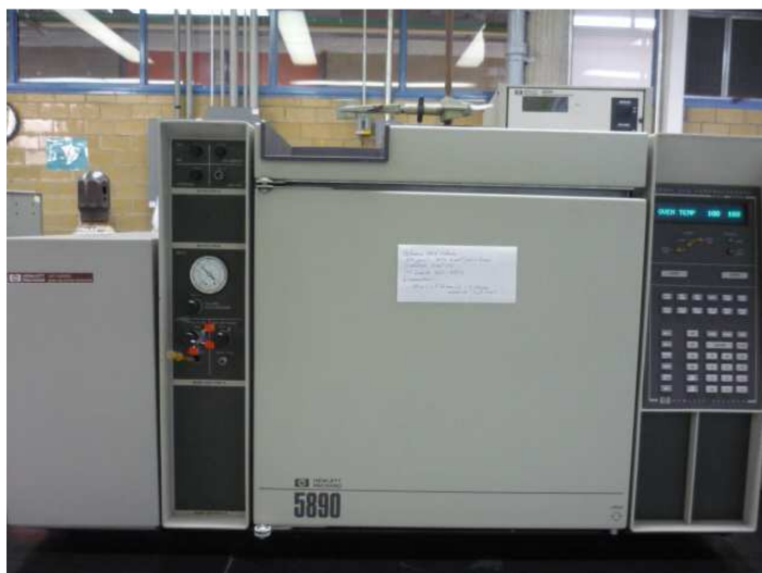
Figura 8. Cromatógrafo de gases acoplado a espectrómetro de masas utilizado en este trabajo (optimización de parámetros, análisis de muestra y cuantificación)
