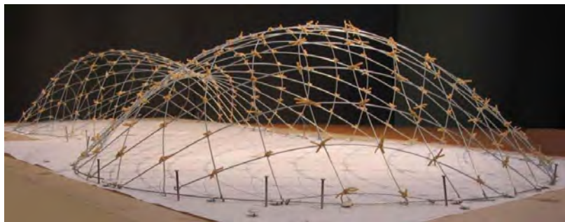
Modelo tridimensional de la malla reticular sobre la superficie existente. 40
