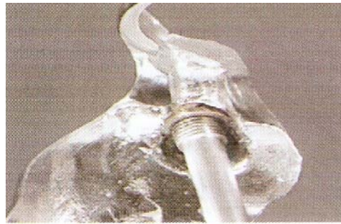
Figura 45. Desatornillar el auxiliar de soldadura
