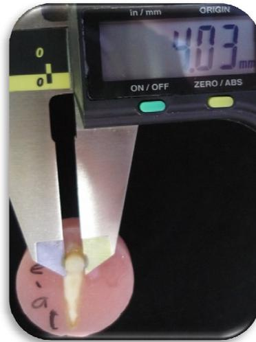
Ya cumplidas las 24 horas de colocadas las resinas, se sometieron a la prueba de fuerza de adhesión en la máquina INSTRON 5567 U.S.A, la cual marca los MPa a los que la resina se desprende de la dentina, esto se realizó en todas las muestras control, y se fueron anotando los resultados de cada una.
