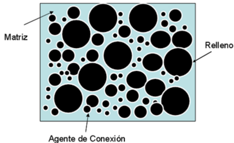
Fig. 2. Componentes fundamentales de las resinas compuestas. Esquema general donde puede verse la matriz de resina, las partículas de relleno y el agente de conexión.
