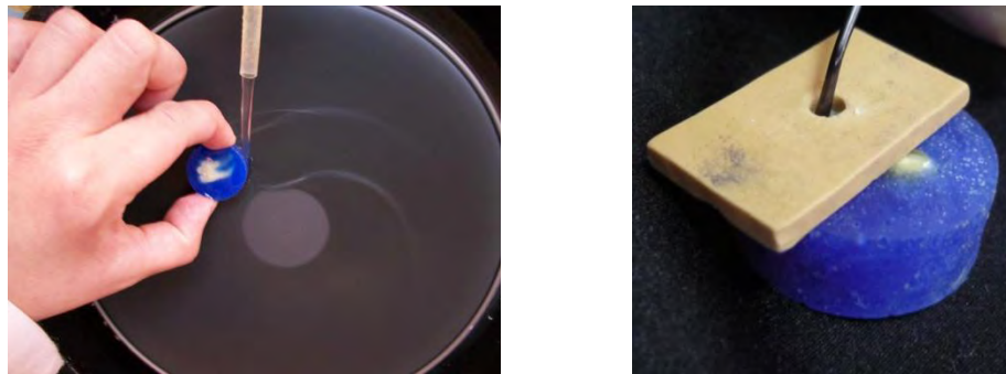
Fig. 11 y 12. Se desgasta el acrílico en el pulidor metalográfico, hasta obtener el área requerida.
