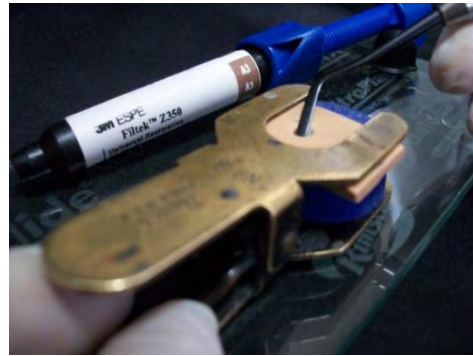
Figs. 20 y 21. Se fija el diente con las pinzas, para llenar el orificio del hacedor de muestras con resina Z350.
