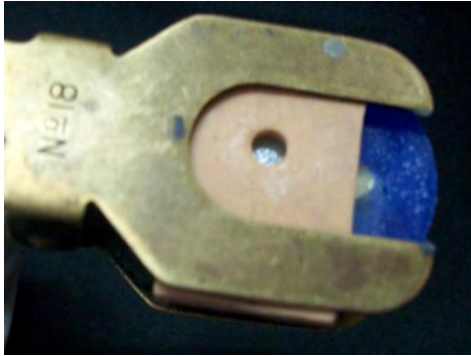
Figs. 20 y 21. Se fija el diente con las pinzas, para llenar el orificio del hacedor de muestras con resina Z350.
