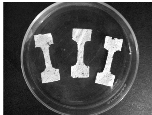
Fotografía 4. Probetas de SPQ utilizadas en el ensayo de tensión
