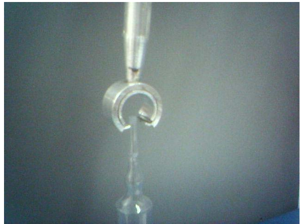
Fig. 5.15. Posición de la ampolleta dentro de la boquilla
