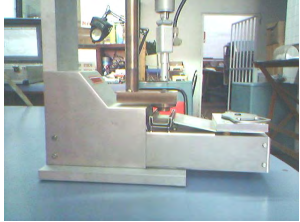
Fig. 5.25. .Detalle del sistema de aire caliente
