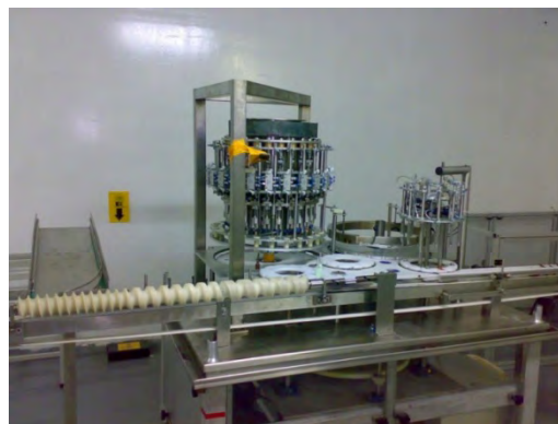
Fig. 5.41. Sistema de indexado y transporte
