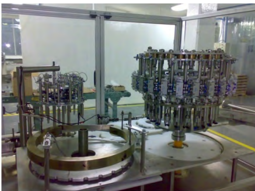
Fig. 5.40. Sistema de llenado, calentamiento y sellado
