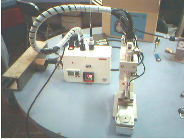
Fig. 5.24. Control de temperatura y sistema de deformación
