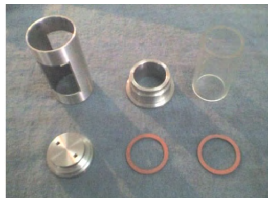
Fig. 5.47. Piezas de la cámara de bombeo
