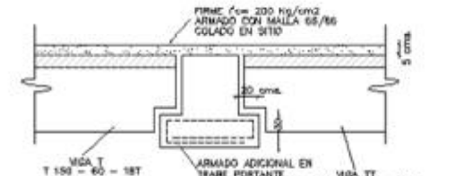
CORTE b-b' LOSA T-TRABE-LOSA TT
