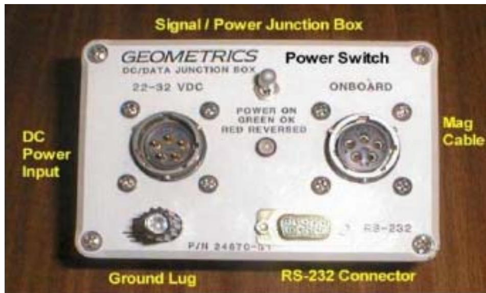
Figura 16. Junction Box para el sistema G877. [Manual del operador, G877]
