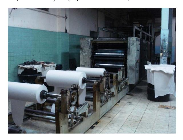
La rotativa es una de las tres clases equipo moderno de prensa, además de la platina y el cilindro. Esta es particularmente eficaz por la rapidez con que trabaja y la economía representa a la larga. Por el método de la rotativa, la impresión se hace a base de planchas curvas enrolladas en los cilindros.
