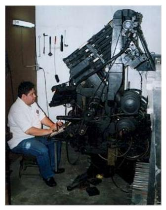
ΕI Operador maneja teclado parecido al de la máquina de escribir, que controla la entrega de las matrices; cuando se oprime una tecla se libera la matriz correspondiente, que cae en el recogedor, equivalente al que utiliza el componedor a mano. Cuando la línea está terminada, las matrices se sueltan, ajustan, funden y distribuyen automáticamente. Mientras ocurre procede linotipista el compone las líneas siguientes.
