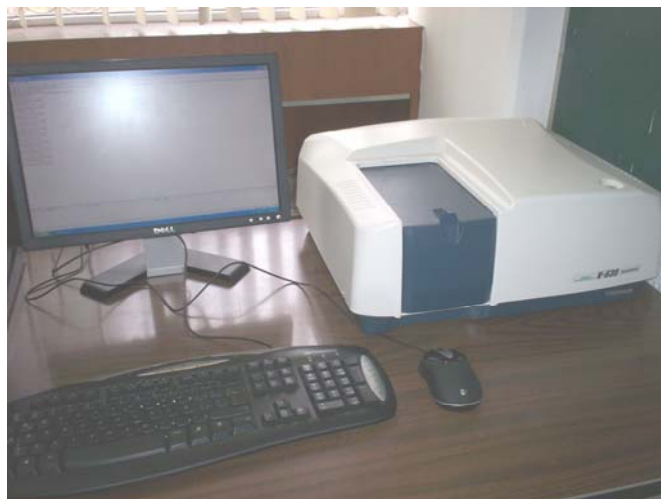
Figura 3.11. Espectrómetro UV-Vis. (Laboratorio Dr. Guillermo Santana y Dra. Betsabè Marel Monroy)
