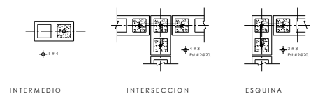
DETALLES DE REFUERZO EN MUROS DE BLOCK.
