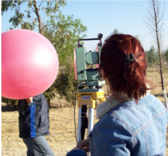
Figura 1.6.: Medición con globo piloto
