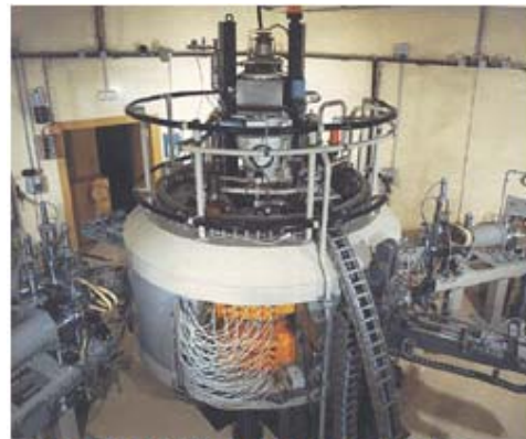
FIG- 42 CICLOTRON COMPLEMENTO IMPORTANTE PARA QUE FUNCIONE EL P.E.T.
