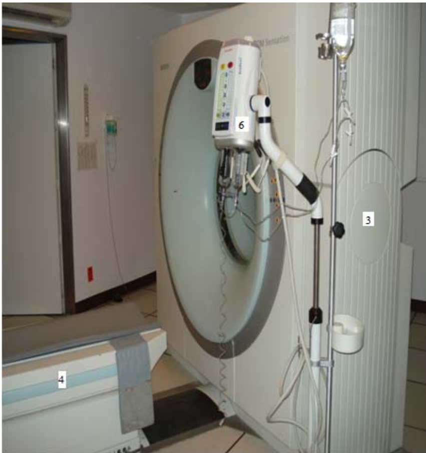
FIG- 50 (3) CABEZAL (4) MESA PARA PACIENTE (6) INYECTOR DE MEDIO DE CONTRASTE, EQUIPO DE TOMOGRAFIA MULTICORTE
