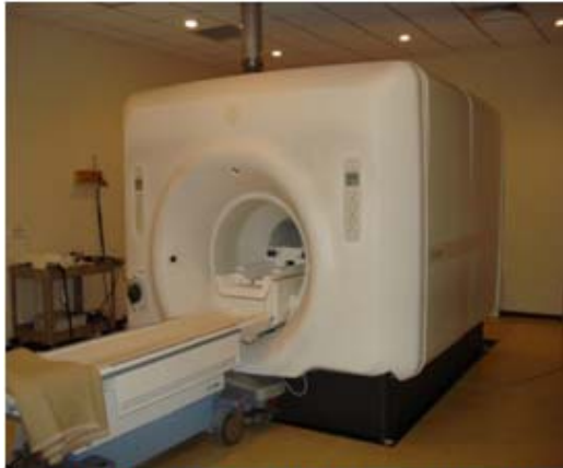
FIG-28 EL RECINTO DE RADIFRECUENCIA ALBERGA EL EQUIPO DE RESONANCIA MAGNETICA
