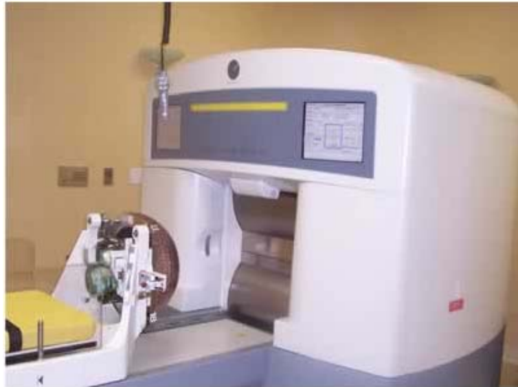
FIG- 55 EQUIPO GAMMA KNIFE, A BASE DE RAYOS GAMMA SE ELIMINAN TUMORES SIN REALIZAR PROCEDIMIENTO QUIRURGICO
