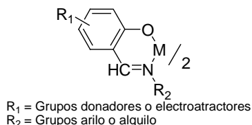
Figura 3.1. Formación de complejos con bases de Schiff.
