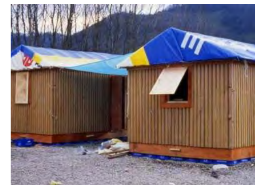
DOCUMENTO DE REGISTRO DE VIVIENDAS - Kobe, Japón, 1994 / Kaynasli, Turquía, 2000 / Bhuj, India, 2001 . Casas-Refugios hechos de tubos de cartón, maderas y lonas de plástico y telas
