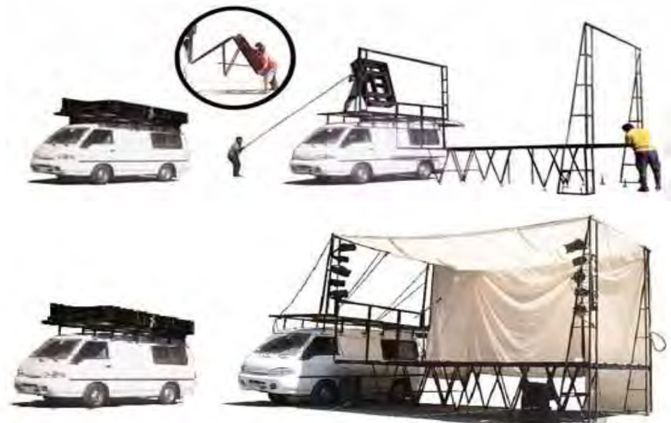
Proyecto itinerante "El Cine vino". Estructura plegable convertida en un escenario móvil destinado para viajar y llevar el Cine a lugares inaccesibles, Chile (2005). Imágenes obtenidas de www.elcinevino.cl/
