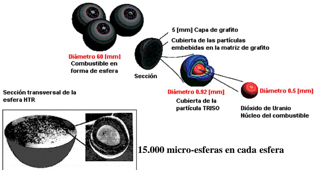
Figura 1.8. Diseño de elemento de combustible para PMBR. [12]
