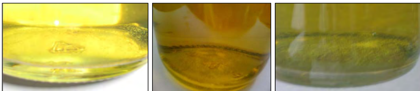
Figura 20, 21 y 22. Presencia de sólidos en la amina.
