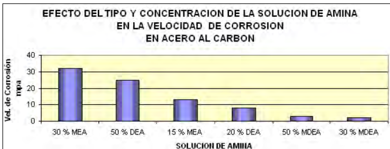
Figura 6. Velocidad de corrosión en acero al carbón (8) .
