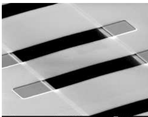
Fig. 1.1 La estructura tipo puente en el medio de la foto es el espejo movable.
