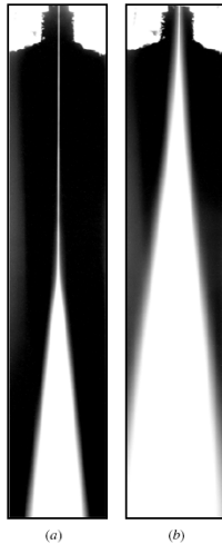
Figura 16. Comparación entre dos chorros de agua con el mismo número Reynolds. El diámetro de salida del barreno es de 128 \mu\text{m} . (a) El diámetro del chorro a la salida del chorro es de 100 \mu\text{m} con un ángulo de entrada recto. (b) El barreno de salida del chorro tiene un diámetro igual al anterior pero tiene un chaflán a 45^\circ en la entrada. [28]
