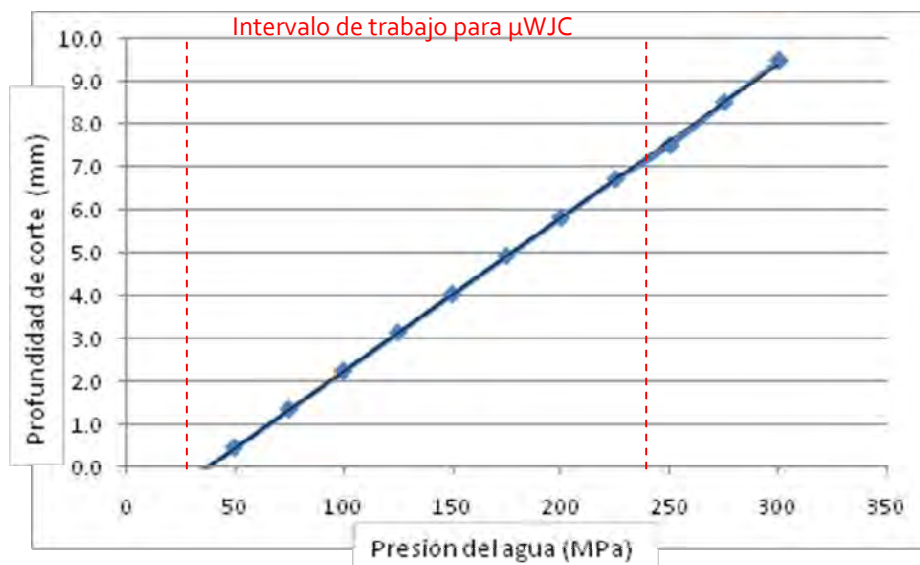
Figura 31. Ejemplo del efecto de la presión en la profundidad de corte (extrapolación a la micromecánica).
