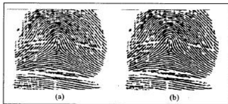
Figura II.17. (a) Imagen filtrada (b) Imagen binaria obtenida
