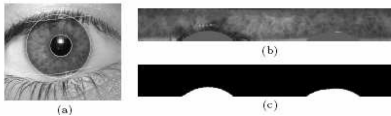
Fig. II. 9.2. Normalización. (a) Imagen segmentada. (b) Iris normalizado. (c) Plantilla de ruido.
