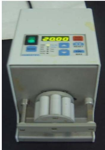
*Figura 7. Foto de la bomba peristáltica (sistema de propulsión).*
