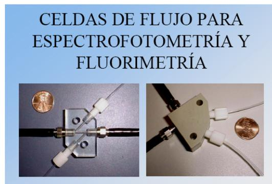
*Figura 11. Celda de Peek. (Zona de detección)*
