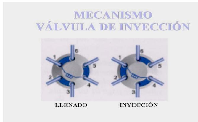
*Figura 8. Mecanismo de acción de la válvula de inyección en sus dos posiciones de llenado e inyección.*
