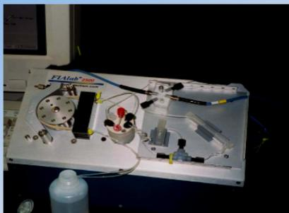
*Figura 12A Ejemplo de un equipo comercial de FIA: incluye una bomba peristáltica (zona de propulsión), zona de reactor, zona de detección.*
