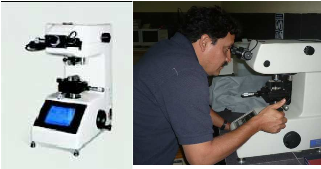
Figura 18. Microdurómetro marca Buehler utilizado en la medición de la dureza de los recubrimientos.
