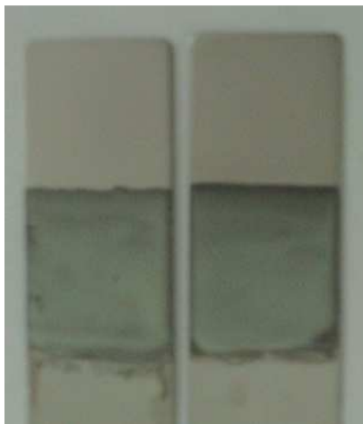
Figura 29. Fotografía de dos depósitos de níquel obtenidos sobre una placa de acero inoxidable AISI 304 utilizando las siguientes condiciones operativas: pH = 1, temperatura del baño = 50 °C, densidad de corriente = 0.027 A/cm 2 y un tiempo de depósito de 40 min.
