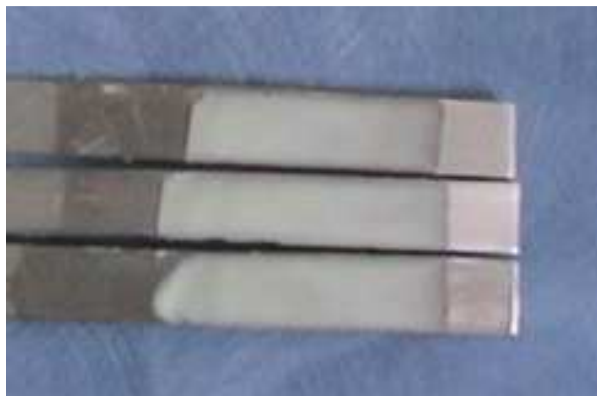
Figura 28. Fotografía de cada uno de los tres depósitos de níquel obtenidos sobre una placa de acero inoxidable AISI 304 utilizando las siguientes condiciones operativas: pH = 1 , temperatura del baño 50\text{ }^{\circ}\text{C} , densidad de corriente = 0.027\text{ A/cm}^2 y un tiempo de depósito de 40 min.
