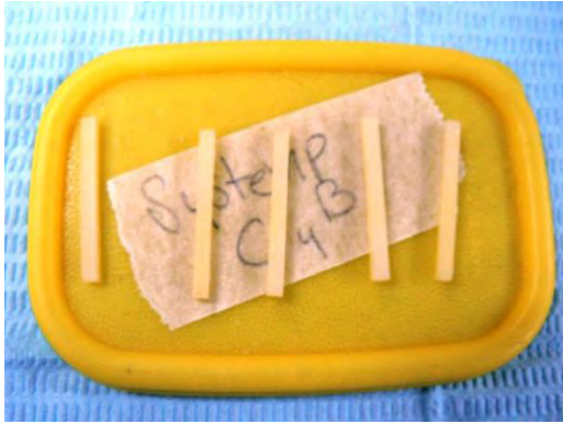
Imagen 5. Muestras de Systemp C&B MR elaboradas para las pruebas de resistencia a la flexión
