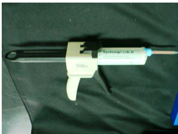
Imagen 1. Cartucho SystempC&B MR montado en su pistola dispensadora y con punta mezcladora
