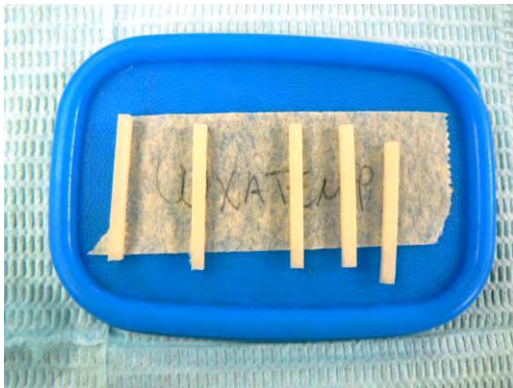
Imagen 7. Muestras de Luxatemp MR elaboradas para las pruebas de resistencia a la flexión
