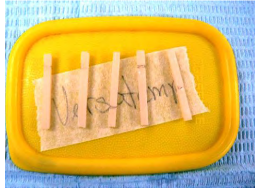
Imagen 6. Muestras de Versatemp MR elaboradas para las pruebas de resistencia a la flexión
