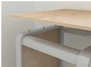
Detalle unión de la cubierta con el larguero, se utilizan pijas, las cuales se ocultan en el canal del larguero.
