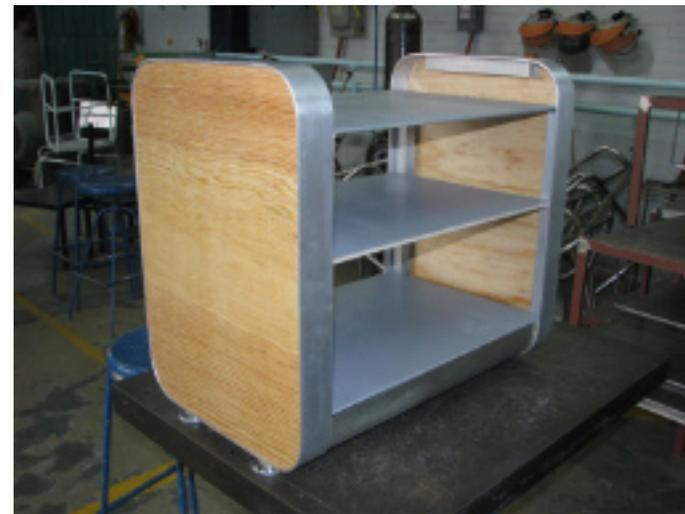
Modelo Escala 1:1 del buró. Los materiales que se emplearon fueron: Aluminio extruido (canal en U), lámina calibre 18, solera, aluminio, triplay 6mm, MDF 6 mm, niveladores.
