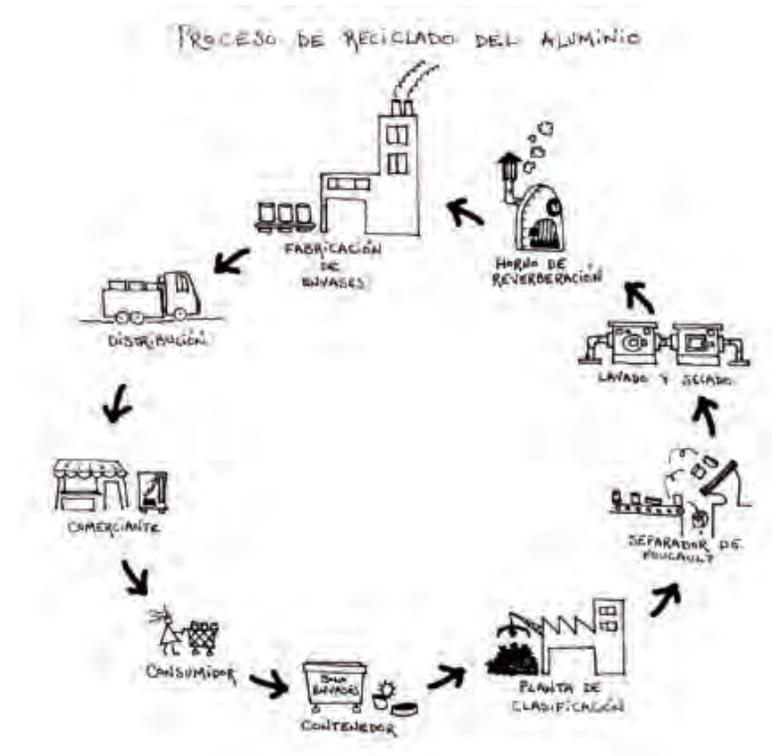
Al igual que ocurre con el acero, el reciclado del aluminio necesita de una separación en origen y de una recogida selectiva previa, este es llevado a una planta de clasificación. Aquí es separado del resto de materiales mediante un Separador de Foucault, sistema que utiliza campos magnéticos opuestos y desvía el aluminio aparte de los otros tipos de envases.
