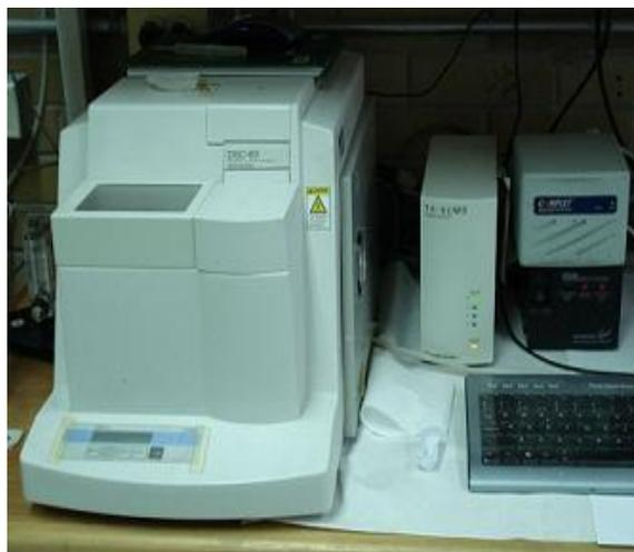
Figura 41. Calorímetro de barrido diferencial DSC TA-60WS.
