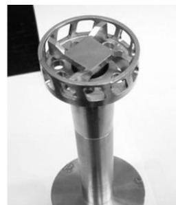
Figura 11. Aspas del rotor-estator (parte superior).
