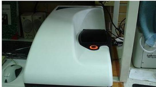
Figura 38. Equipo Zetasizer® ZS de la serie Nano.
