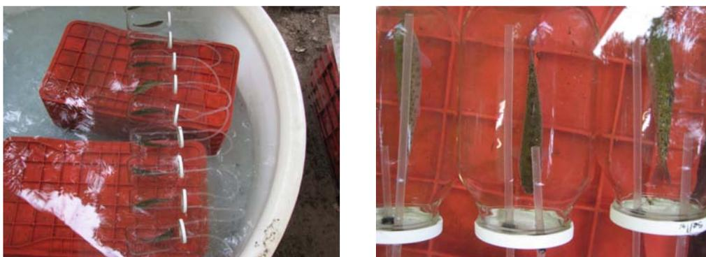
**Figura 4.-** Peces dentro del respirómetro para la evaluación de consumo de  $\text{O}_2$ , producción de  $\text{NH}_3$  y  $\text{PO}_4$ .
