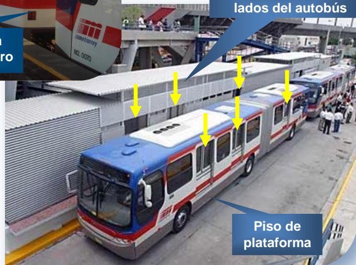
Puertas de ascenso y descenso en ambos lados del autobús
