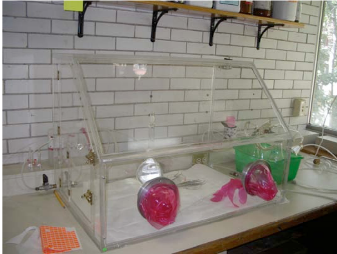
Figura 20.- Caja de guantes en donde se manipulan los difusores pasivos para su preparación antes y después del muestreo.
