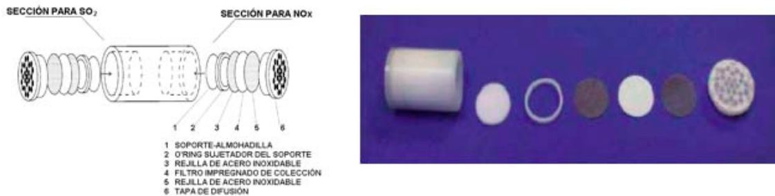
Figura 10.- Componentes de un difusor pasivo para determinar \text{SO}_2 y \text{NO}_x (Fuente: http://www.ogawausa.com ).
