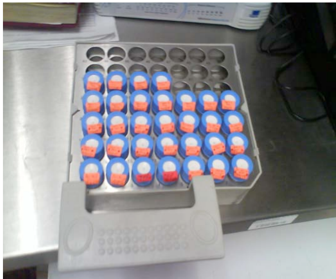
Figura 22.- Charola del automuestreador AS50 para cromatógrafo de iones, que contiene extracto de muestras en viales de inyección
