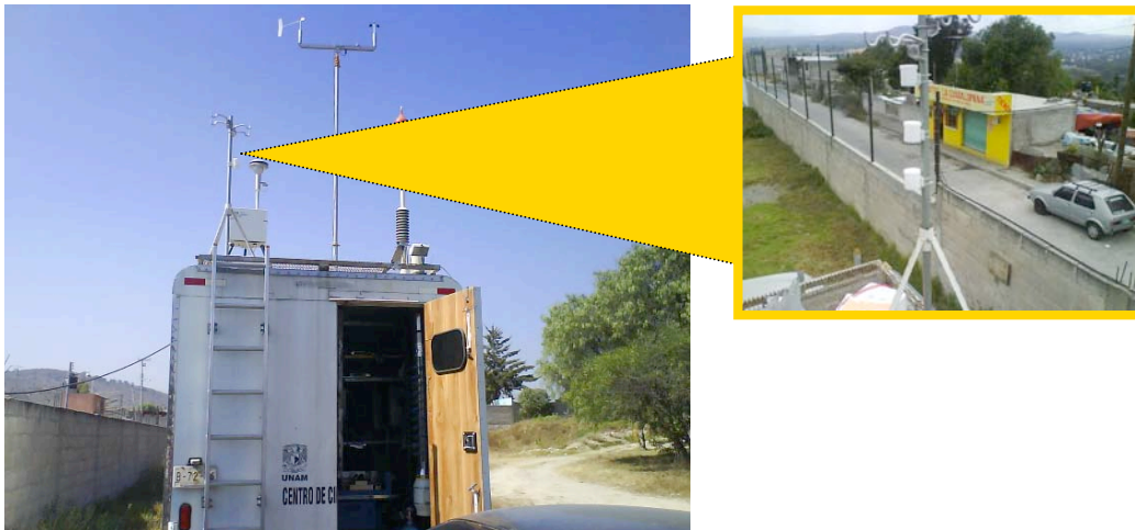
Figura 18 .- Prueba de tiempo de exposición contra respuesta en la concentración de \text{SO}_2 y \text{NO}_x
