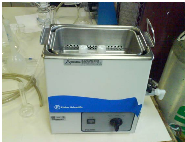
Figura 21.- Baño ultrasónico Fischer Scientific, utilizado para realizar la extracción por ultrasonido de los filtros de SO 2 y NO x de difusores pasivos.
