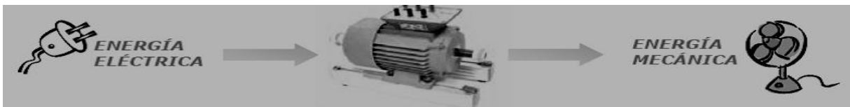
Fig. 2.1. Proceso de transformación de energía en un motor.
