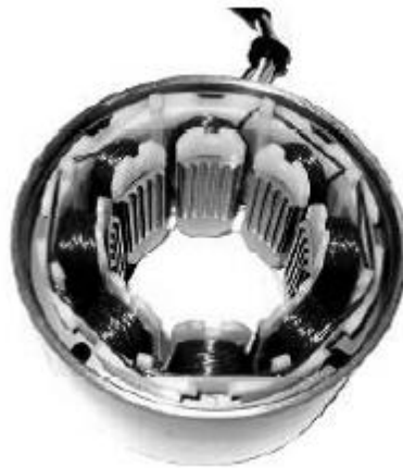
Fig.2.14. Aspecto constructivo del estator: 8 polos y vista de los dientes interiores de cada polo.
