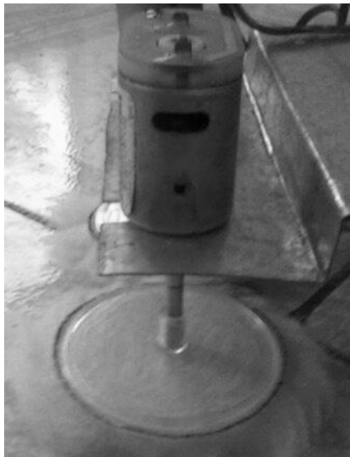
Fig.4.6. Motor con disco pulidor.
