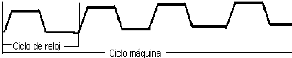
Fig.3.26. Ciclo de máquina para el microcontrolador.
