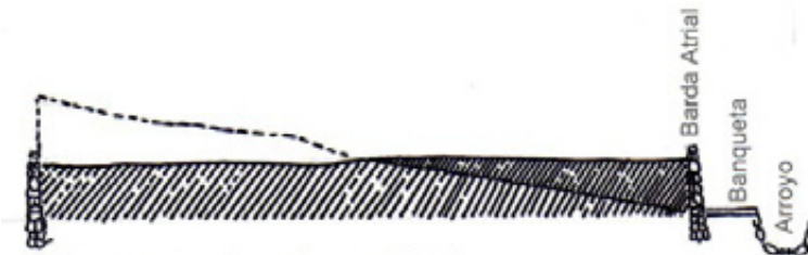
Terreno reconfigurado y renivelado
