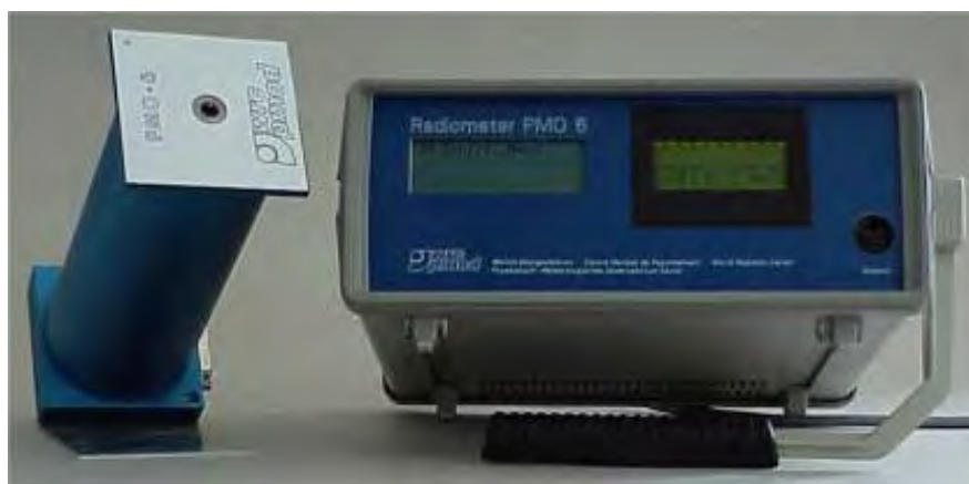
Figura 1.7. Pirheliómetro de cavidad absoluta, serie PMO-6.
