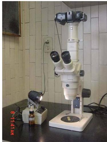
Foto 1 Microscopio estereoscópico
