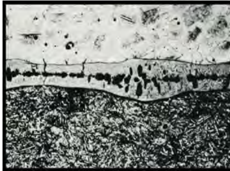
Fig. 3. Forma típica de recta con cierta capa de aleación entre las placas (Unión Incotel y Acero Inoxidable)
