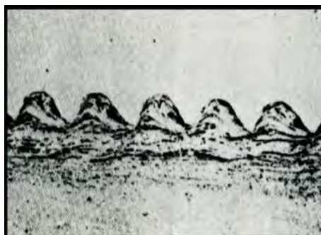
Fig. 2. Forma típica de la onda (Unión acero inoxidable y cobre)
