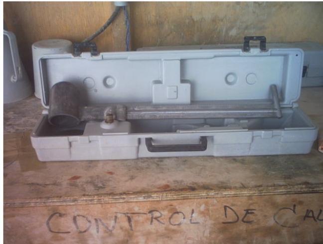
Fig. IV.7.3.a Balanza Baroid
