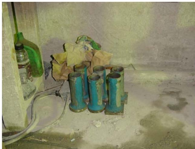
**Fig. IV.7.5 Moldes para cilindros de prueba**
