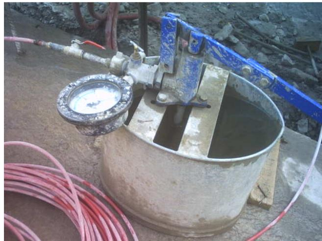
Fig. III.2.4.b Bomba manual para saturar al obturador
