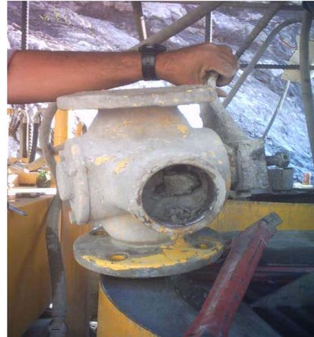
Fig. III.8.4.b Taponamiento del cabezal de descarga
