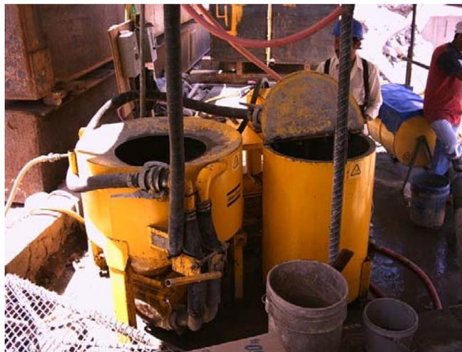
**Fig. III.2.1.1 Turbomezclador de altas revoluciones y Agitador de bajas revoluciones**
