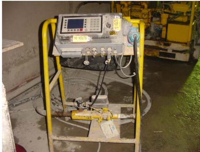
Fig. III.5.2.c CPU LOGAC para medir el flujo de inyección de lechada
