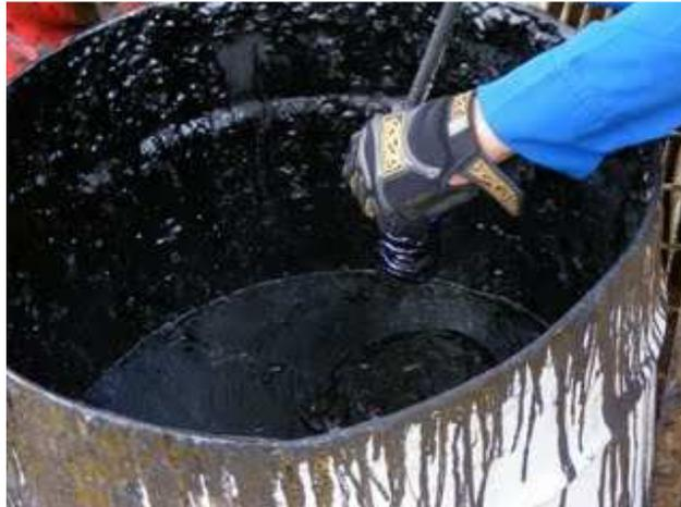
*Figura 1.3 Ejemplo de un crudo pesado clase A, (Tecnologías de mejoramiento de crudo pesado, extrapesado y bitumen, PEP 2008).*
